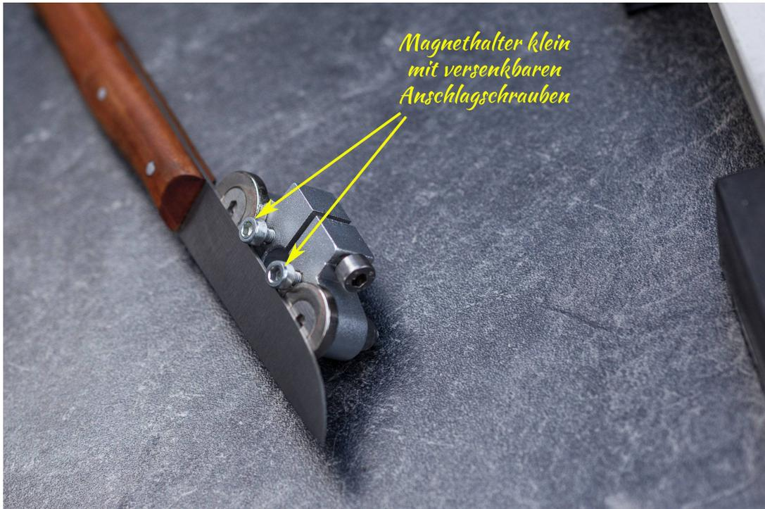
Für etwas größere Klingen wie bei Foldern können die Schrauben rein gedreht werden um die gesamte Magnetfläche zu nutzen
