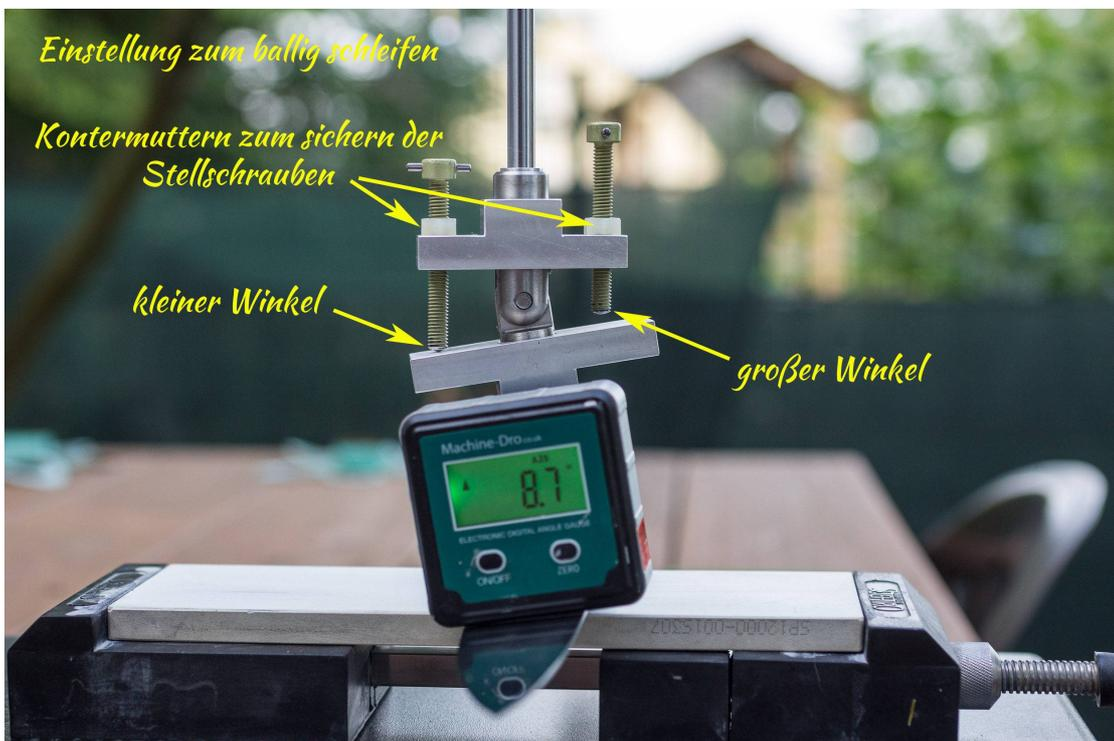
Normalerweise habe ich das Gelenk leicht schwergängig eingestellt, zum ballig schleifen die Klemmschraube etwas lösen so das das Gelenk sich leicht bewegen lässt.
