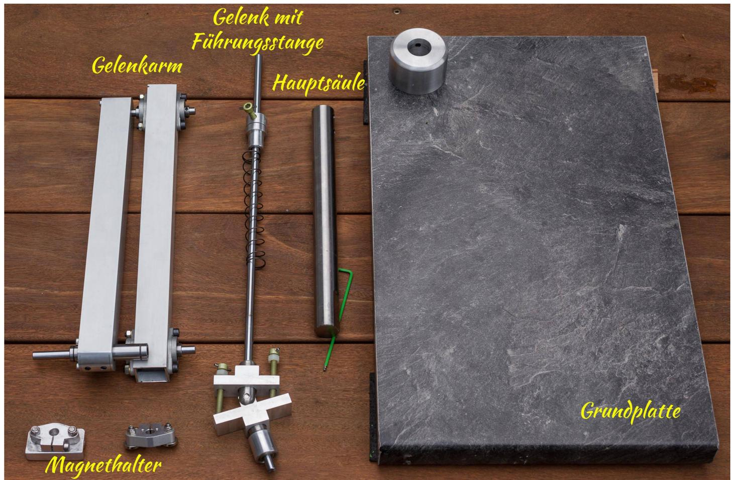
Die Hauptsäule mit der Spannfläche nach hinten in die Grundplatte einstecken und mit den Madenschrauben festklemmen
